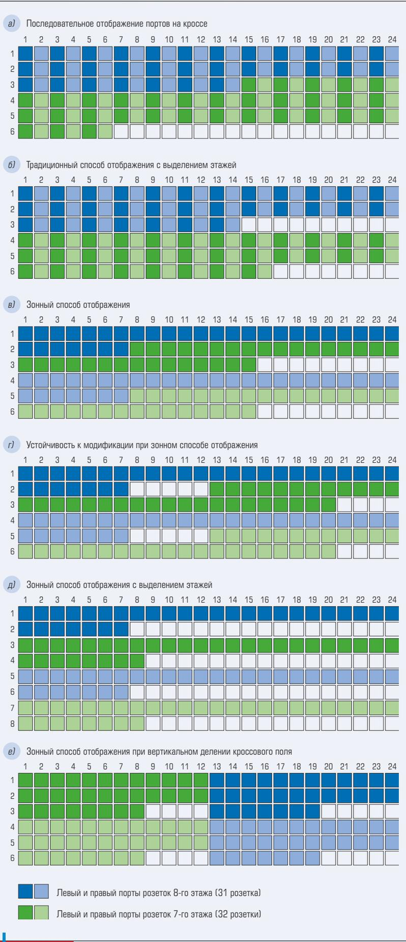
Рис. 3. Различные способы отображения портов рабочих мест на кросс-панелях
