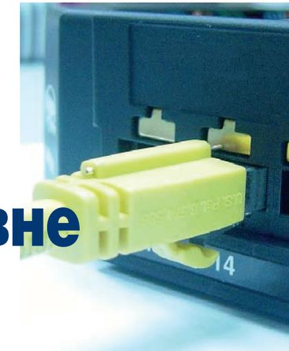
дником. При соединении портов коммутационным шнуром контакты-датчики шнура упираются в контактные площадки панели и замыкают электрическую цепь между ними. По этому признаку анализатор, постоянно опрашивающий состояние портов, распознает соединенные порты и отправляет соответствующую информацию на сервер iTRACS. Следует отметить, что при этом сохраняется стандартный RJ45-интерфейс на 8 контактов.
